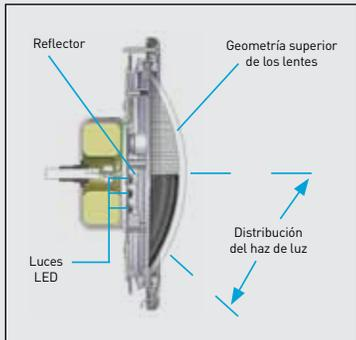
El dibujo muestra los diseños exclusivos de lente y reflector, que se combinan para ofrecer una óptima distribución del haz de luz.
