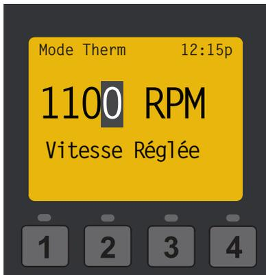
Réglage de la vitesse de la pompe en mode thermique
